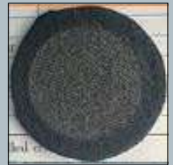
Na schuur test >8000 herhalingen zonder dat het materiaal kapot gaat
