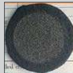
Efter nötnings-test >8000 cykler utan att materialet går sönder
