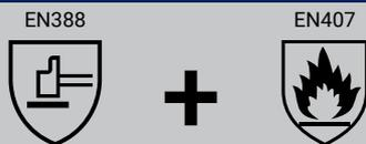
La norme EN12477:2001 s'adresse explicitement aux gants conçus pour être utilisés lors des opérations de soudage et processus similaires. Cette norme est constituée d'une combinaison de l'EN420 (exigences générales en matière de gants), de l'EN407 (protection contre les risques thermiques, la chaleur et le feu) et de l'EN388 (protection contre les risques mécaniques).
