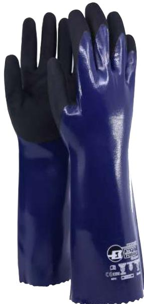
Gant résistant aux produits chimiques (type B) en nylon extrêmement fin avec un ajustement et un confort supérieurs. Double revêtement en nitrile avec la couche externe en nitrile micro expansé avec une bonne adhérence dans des conditions sèches, humides et huileuses. Double revêtement en nitrile sur tout le pouce pour une durabilité accrue. Sans butadiène. Conception ergonomique pour moins de fatigue des mains et une meilleure expérience utilisateur.
