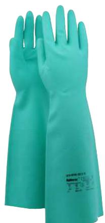
Gant long de protection chimique en caoutchouc nitrile de première qualité avec une excellente résistance aux graisses, aux solvants aromatiques et pétroliers. Motif en diamant surélevé dans la paume pour une meilleure adhérence dans les environnements humides et huileux. Sans doublure. Approuvé pour la manipulation des aliments. Sans silicone. Longueur (mm) : 450 +/- 10, Épaisseur (mm) : 0,58 +/- 0,03
