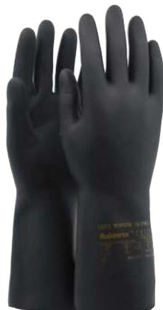
Gant de protection chimique lourd en composé de caoutchouc néoprène/latex spécialement formulé pour un usage industriel. Surface durcie pour une plus grande résistance aux produits chimiques et à l'abrasion. Intérieur floqué en coton pour plus de confort. Approuvé pour la manipulation des aliments. Sans silicone. Longueur (mm) : 320 +/- 10, Épaisseur (mm) : 0,68 +/- 0,03
