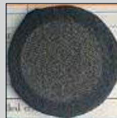
Después de la prueba de abrasión >8000 ciclos sin romper el material
