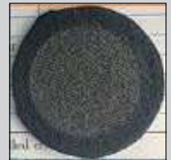
Nach Abriebtest >8000 Zyklen ohne Bruch des Materials
