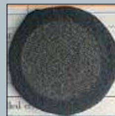
Dopo la prova di abrasione >8000 cicli senza rompere il materiale
